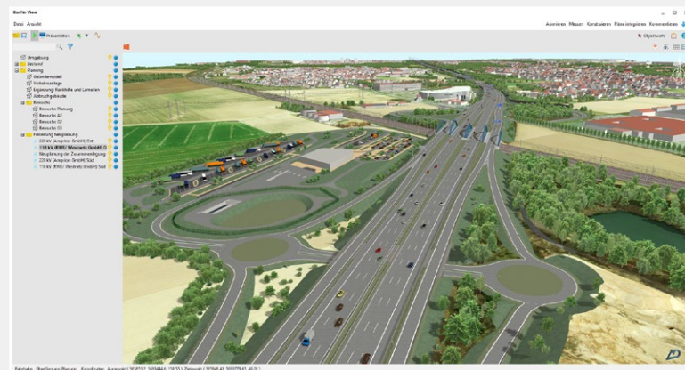
KorFin Gesamtmodell aus Bestand (ausgeblendet) und Planung mit parametrisierten Fachobjekten
