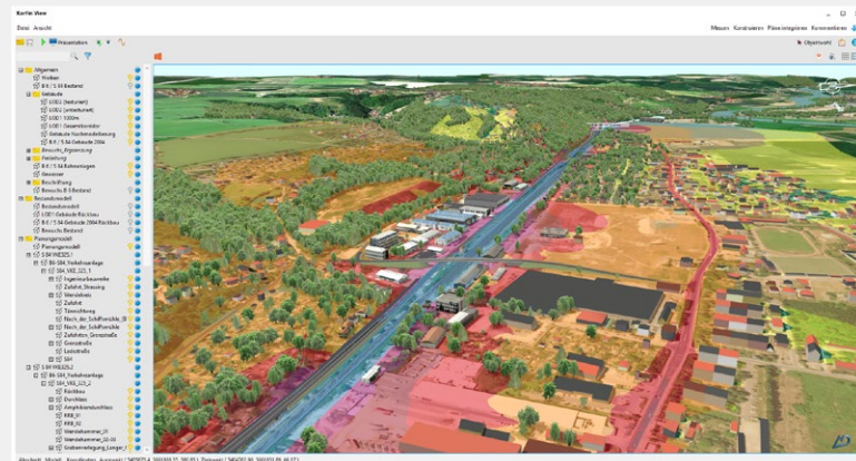
KorFin Gesamtmodell mit Ergebnissen einer Schallimmissionsberechnung
